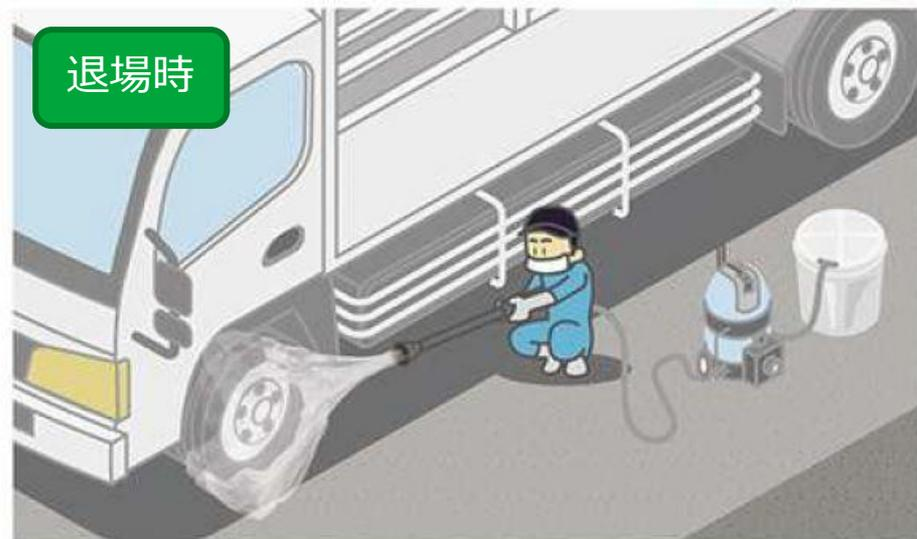
▲退出時の動力噴霧器を用いた車両消毒風景
