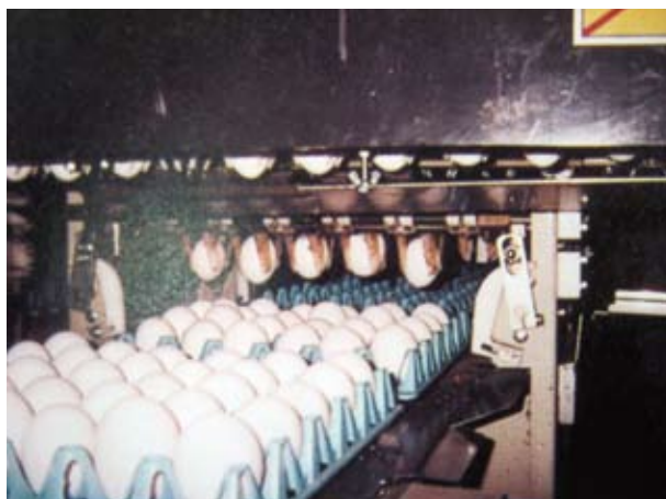
図21. パッカーでの破卵発生箇所
